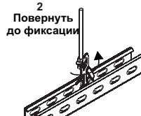
Пример крепления при помощи цепи и подвески WBC40 к швеллеру CWC40H47
