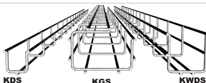
Проволочный лоток KDS, высота лотка: H35 мм, ширина лотка: 35, 50 мм Проволочный лоток KGS, высота лотков: H60 мм, ширина лотка: 60-100 мм Проволочный лоток KWDS, высота лотка: H60 мм, ширина лотка: 60 мм
