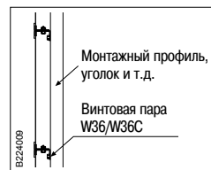
Крепление профиля к стене.
