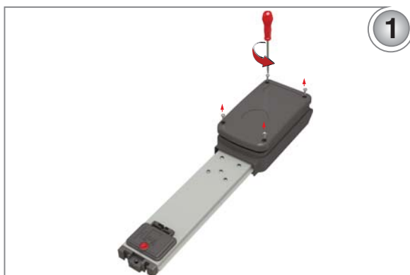
1- Используя отвертку, открутите шурупы питающего модуля.
