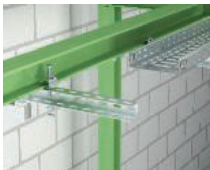
Консоль на стальной балке С помощью фиксаторов TKS-L-25 U-образные стойки можно устанавливать на стальных балках. Для придания прочности конструкции необходимо установить распорки DSK.
