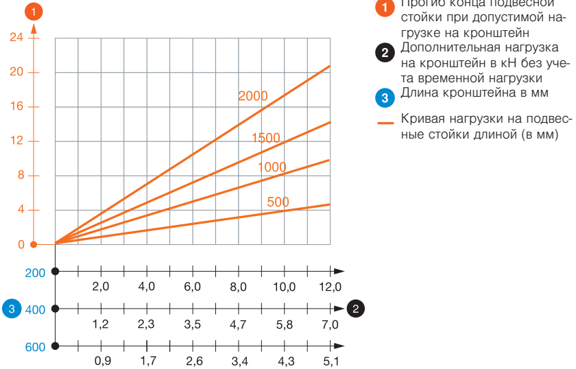
Значения нагрузки на дюбели для подвески IS 8 K
