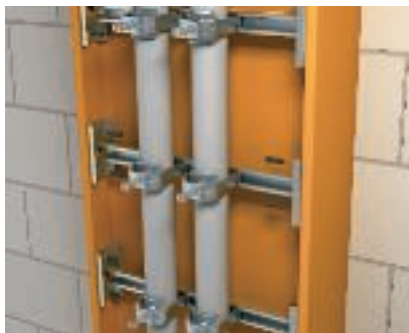
Крепление перекладин на стальных балках Прямое крепление (с помощью фиксаторов) опорной пластины SAA с профильной рейкой CPS 4 на стальной балке.
