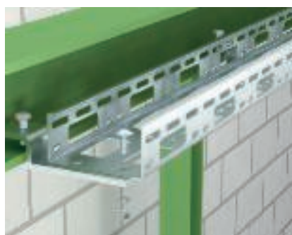
Горизонтальное крепление с помощью фиксаторов Монтаж мини-канала AZ с помощью фиксатора BFK при направлении прокладки трассы вдоль стальных балок. Максимальная ширина кабельного лотка 100 мм.
