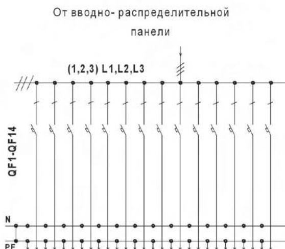
Рис. 3.3.6 Схема электрическая принципиальная блока автоматического управления освещением на 14 групп
