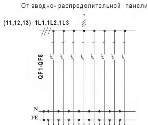
Рис. 3.3.8 Схема электрическая принципиальная блока автоматического управления освещением на 8 групп
