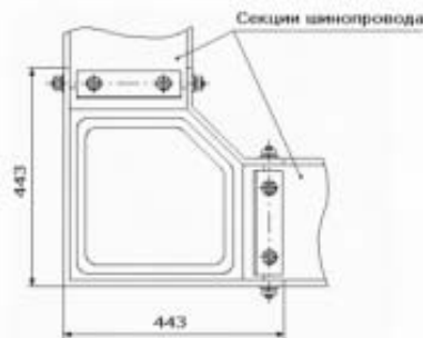
Рис. 5.2.22 Комплекты угловых крышек
