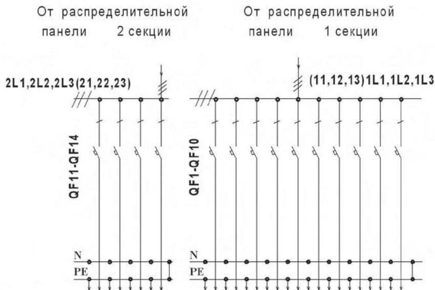
Рис. 3.3.4 Схема электрическая принципиальная блока автоматического управления освещением на 14 групп
